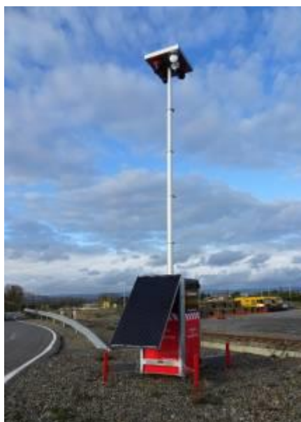
Le mât télescopique est coiffé par 3 ou 4 caméras dômes de détection. @ IP-Mirador
